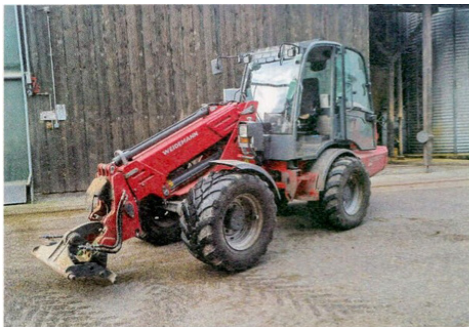
Le valet de ferme est employé avec une pelle, une pince à balles ou encore une balayeuse. Photo: Dominic wyss
