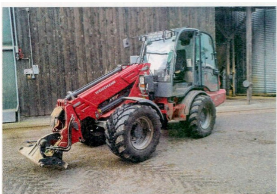
Der Hoflader wird mit einer Schaufel, einer Ballenzange oder einer Kehrmaschine eingesetzt. Bild: Dominic Wyss
