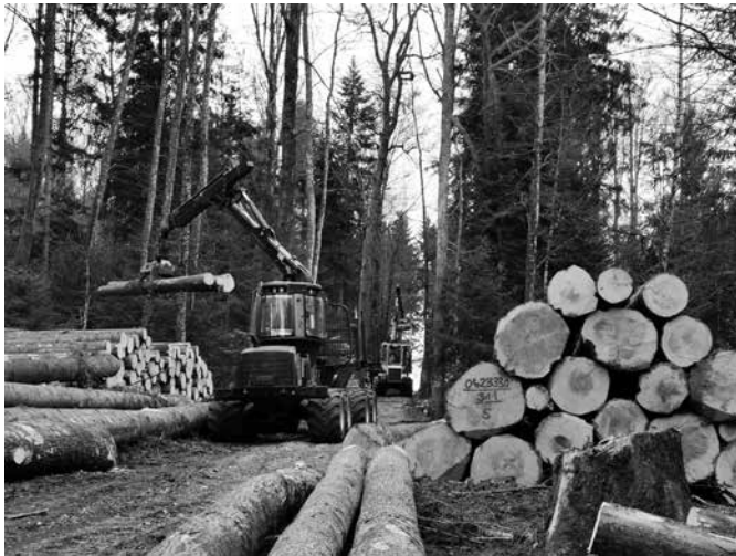
Der Vollernter (hinten) fällt die Bäume und astet sie auf. Mit dem Forwarder (vorne) werden die Stämme aus dem Wald an die Waldstrasse transportiert
