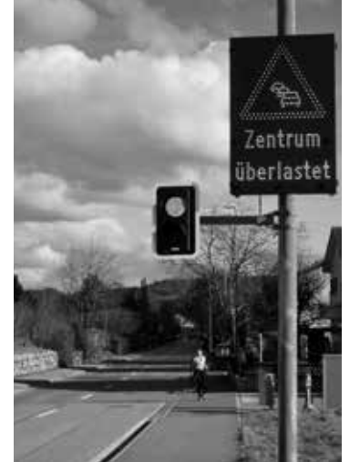
Die Dosieranlage wird den Verkehr am Ortseingang aufhalten, wenn sich die Fahrzeuge im Ortszentrum stauen. (Bild: A. Maradan)
