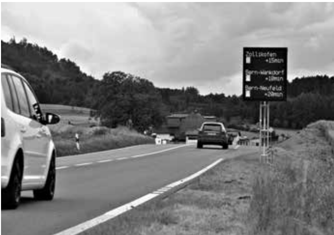
Verkehrsinformationstafel mit Testbild auf der Bernstrasse zwischen Hindelbank und Urtenen (Bild: A. Maradan)
