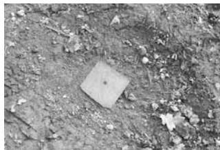
Ein neu gesetzter Marchstein mit dem genauen Messpunkt in der Mitte
